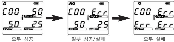
스펠 교정 후, 성공한 스펠 교정 값을 저장하고 ON/OFF 버튼을 5초동안 누르면 스펠 교정 모드에서 빠져나간다. 테스트 통과 아이콘
