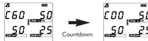
Note : 만약 30초 동안 어떤 가스도 검색되지 않으면, 경보음과 경보램프가 1회 작동되고 LCD 표시창에 "Err"이라고 표시되며, 테스트 실패 아이콘
